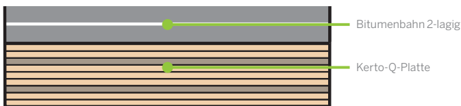
a) BEI 2-LAGIGER BITUMENBAHN g_{\text{Auf}} = 0,15 \text{ kN/m}^2
